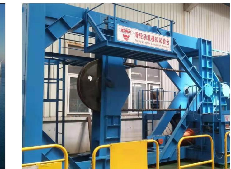
滑轮动载试验台在工厂作重载荷试验
