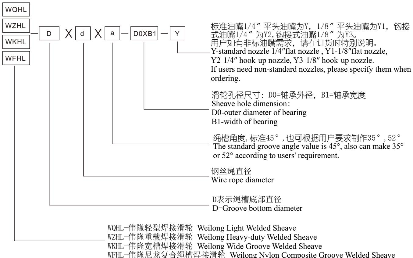
示例：预订购宁波伟隆轻型焊接滑轮，滑轮绳槽底径D=1000，适用钢丝绳直径d=32，绳槽断面角度a=45°，滑轮内孔直径D0=290，滑轮轮毂宽度B1=118，标准油嘴1/4" 平头油嘴，则标记为：
