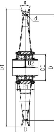
图5 标准绳槽滑轮 Figure 5 Standard rope groove sheave
