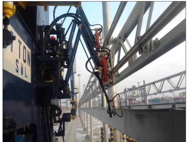
受电滑板 and 滑线紧密接触
